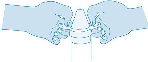
5. Entfernen Sie den Trichter und bringen Sie den Zylinder am Vacuum Handbuch System an. Drehen Sie den Vacuum Handbuch System zu 90° bis dieser im Zylinder einhakt. Überschrauben Sie den Vacuum Handbuch System nicht. Setzen Sie den Pufferring in das offene Ende des Zylinders.
