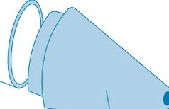
Trichter, der an dem Zylinder angebracht werden kann, um die Anbringung des Rings auf dem Zylinder zu erleichtern.
